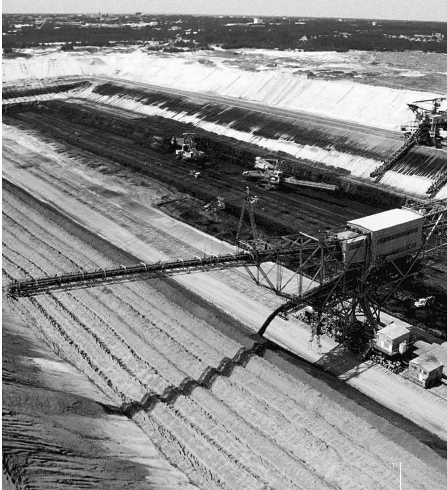
Abraumförderbrücke F 34-27 im Tagebau Cottbus-Nord, 1996
